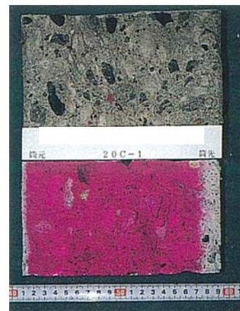
コンクリートコア割裂による中性化測定
