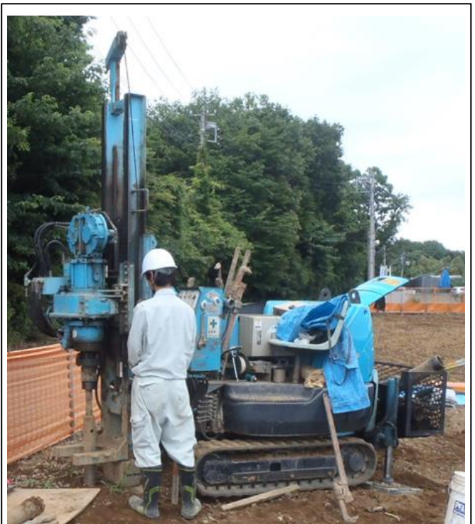
自走式ボーリング機械。 回転機構とバイブレーション機構により、 無水掘りで試料を採取する。
