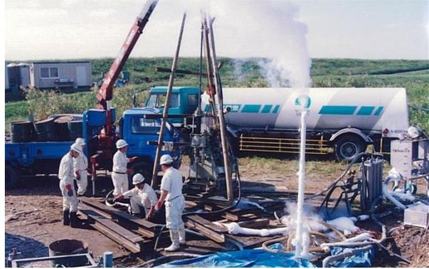
砂質土の採取（採取試料径 φ65mm）
