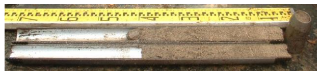
写真-1 SPT サンプラーによる砂試料の採取状況
