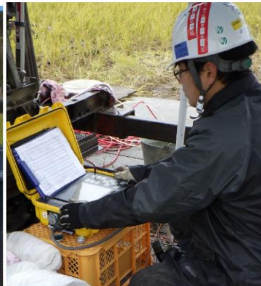
ボーリング孔を利用して原位置試験を行います。 (プレッシャーメーター試験)
