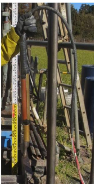
ボーリング孔を利用して原位置試験を行います。 (プレッシャーメーター試験)
