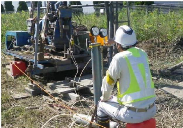
ボーリング孔を利用して原位置試験を行います。 (プレッシャーメーター試験)
