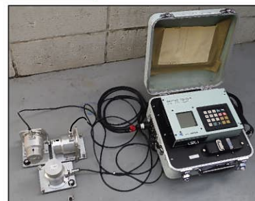
図1 常時微動計測器 微動計(左)とデータロガー(右)
