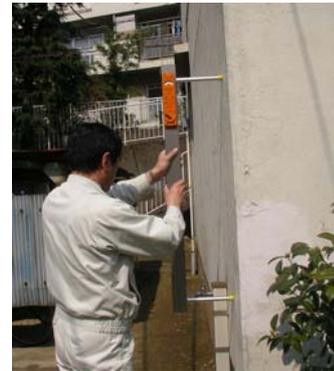
傾斜計による建物の傾斜測定
