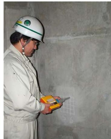
非破壊による強度測定
