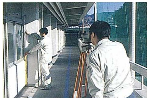
水準機による建物の不同沈下測定
