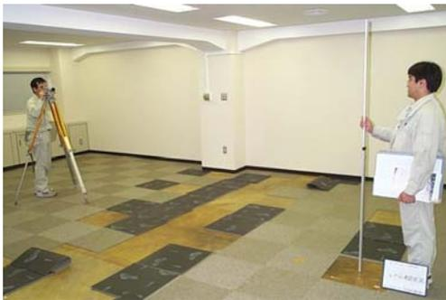
水準機による床のたわみ測定
