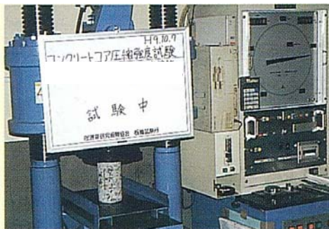
圧縮強度による強度測定
