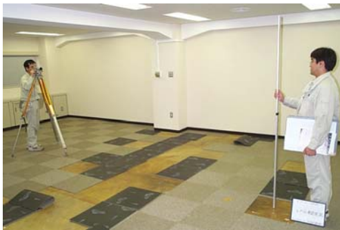
水準機による床のたわみ測定
