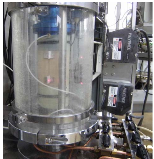
レーザー変位計測定状況
