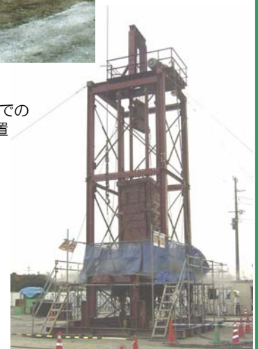
写真-2 重錐質量 20kN 以上の場合の載荷装置 (重錐 500kN の装置)
