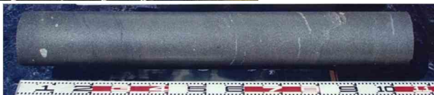
採取した砂礫試料（試料径 \phi 300mm）
