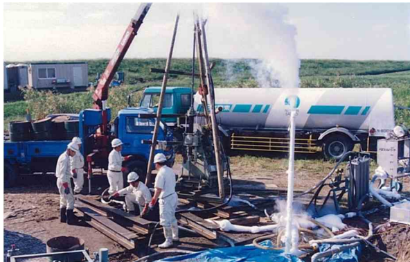
砂質土の採取（採取試料径 \phi 65mm）
