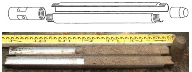
写真-1 標準貫入試験用サンプラーによる砂試料の採取状況
