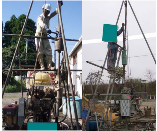
写真-2 標準貫入試験実施例(左:トソビ使用、右:半自動落下装置使用)
